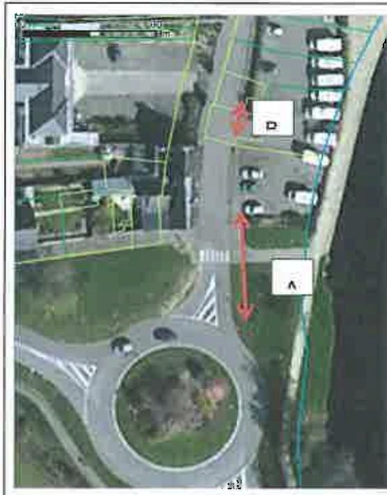
La zone A doit être réhaussée d'une trentaine de centimètres dans le cas crue de 1995. Une solution par merlon en terre semble la plus adaptée. C'est ce secteur qui survivra en premier (déversoir de sécurité) ; il pourrait donc être protégé par une géogrille.
