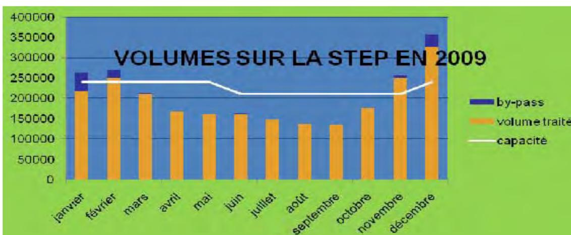
Le graphique ci-dessus montre clairement le problème lié aux eaux parasites. Pendant 4 mois, de novembre à février, du fait d'une pluviométrie importante, le volume des eaux à traiter dépasse la capacité hydraulique de la STEP, conduisant à des rejets dans le Blavet après seulement quelques prétraitements. En outre ce volume d'eau supplémentaire à traiter augmente dans des proportions importantes, la dépense d'énergie électrique des divers équipements.
